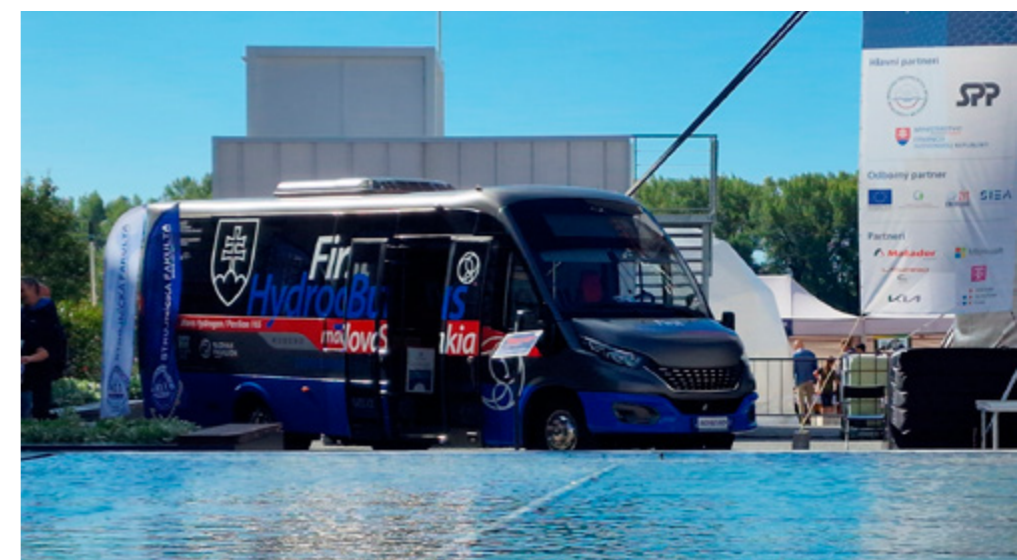
Prvý vodíkový nízkotlakový autobus využívajúci na uskladnenie vodíka metalhydridové materiály vytvorený v spolupráci Sjf TUKE a firmy ROŠERO-P, s. r. o.
